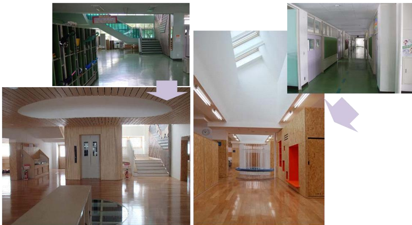
オープンスクール化をテーマとした北海道黒松内町立黒松内小学校の長寿命化事例 （※1 p91） エレベーター設置によるバリアフリー化/吹き抜けや高窓設置による開放的な環境づくり
