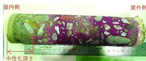
コンクリートの中性化深さ
