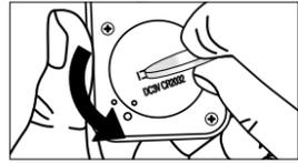
① 本体裏面の電池フタの溝へコインなどをあわせる。
