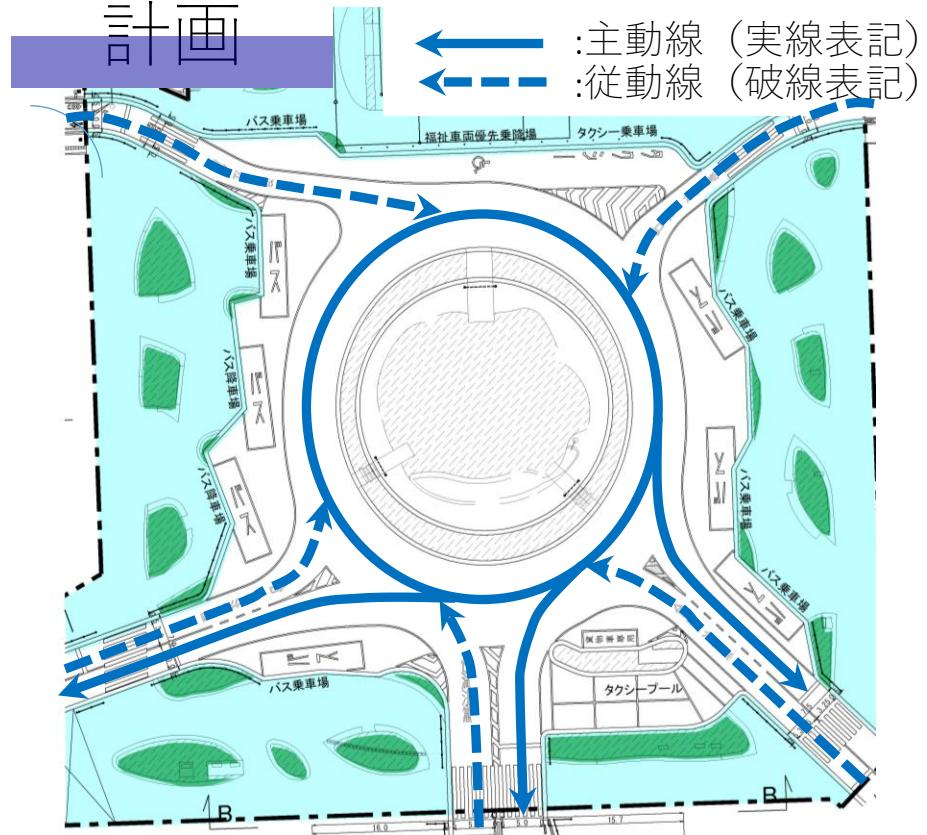
環状道路を**主動線**、環状接続道路が**従動線**と考え、接続道路が環状道路に接続する箇所で環状道路の**優先**が確保できるようにする
