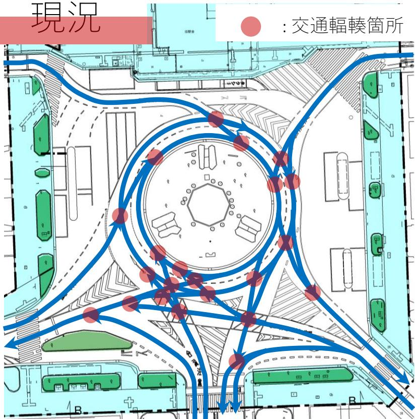
ロータリーが**複数車線**で運用されているためロータリーと取り付け道路の**主従関係**が明瞭でなく複数車両による**輻輳**が生じている
