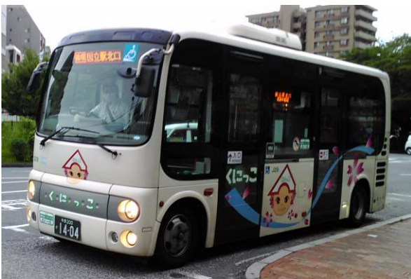
小型バスの例（車幅約 2.08m 定員約 30 人） ワゴン車両の例（車幅 1.88m 定員 10 人）
