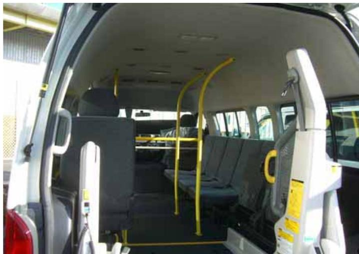
写真2 車幅 1.88m の乗り合い仕様のシートレイアウト(横乗り)
