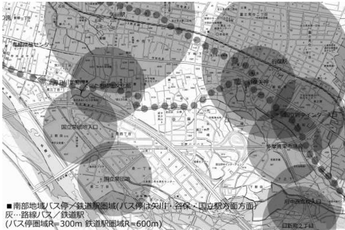
図 3 コミワゴン運行開始前の時間帯の停留所圏域 (R=300m)
