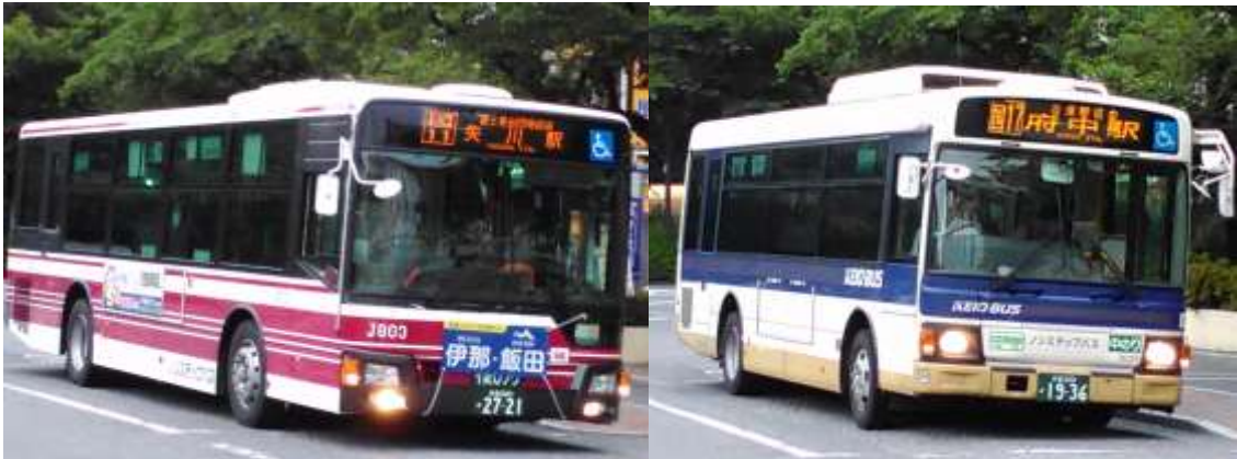
大型バスの例（車幅約 2.5m 定員約 80 人） 中型バスの例（車幅約 2.3m 定員約 60 人）
