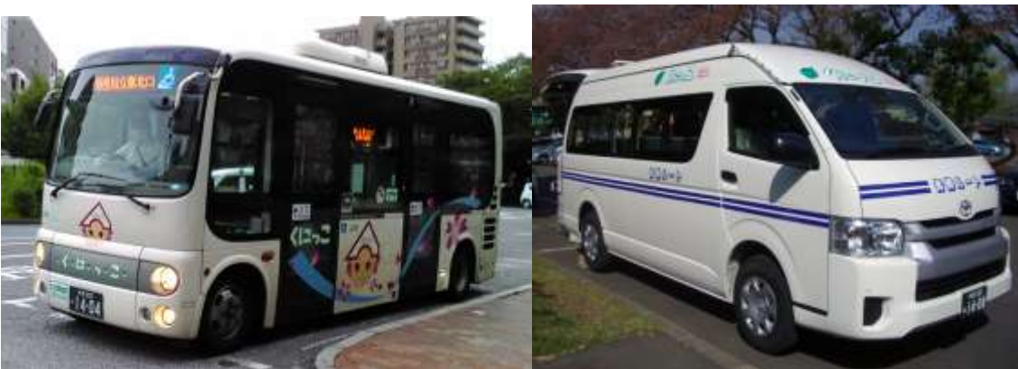
小型バスの例（車幅約 2.08m 定員約 30 人） ワゴン車両の例（車幅 1.88m 定員 10 人）
