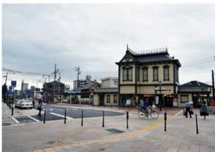
広場と通行路は一体の自然石舗装となっており、スレンダーなポラードが通行路範囲を明示している
