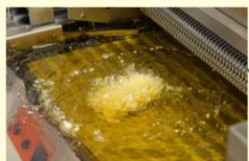
⑦揚物・焼物・蒸し物室 連続揚物機は1時間で4,000食、焼物や蒸し物は1度に770食調理できます。
