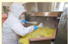
⑥炊飯室 5,000食を82個の釜で連続炊飯します。※写真はターメリックライス
