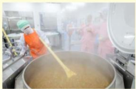
⑧煮炊き調理室 回転釜を11機配置し、1機の回転釜で汁物を1,000食調理できます。
